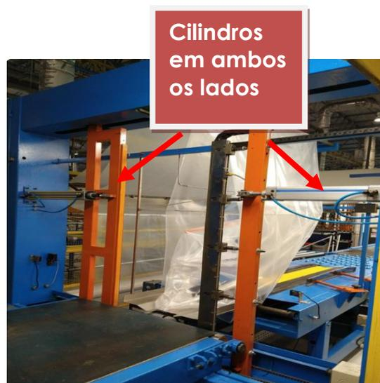
Figura 8: Novo sistema de tração da corrente com dois cilindros
